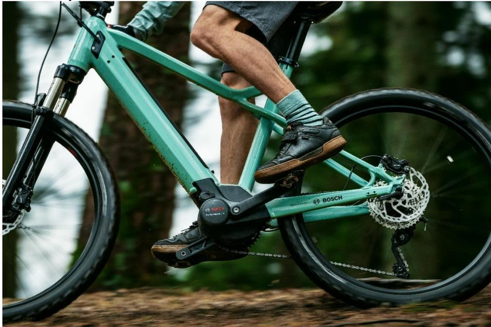
Avec un couple maximal de 65 Nm et une assistance pouvant atteindre 300 pour cent, le moteur déploie assez de puissance pour les cyclistes sportifs.
